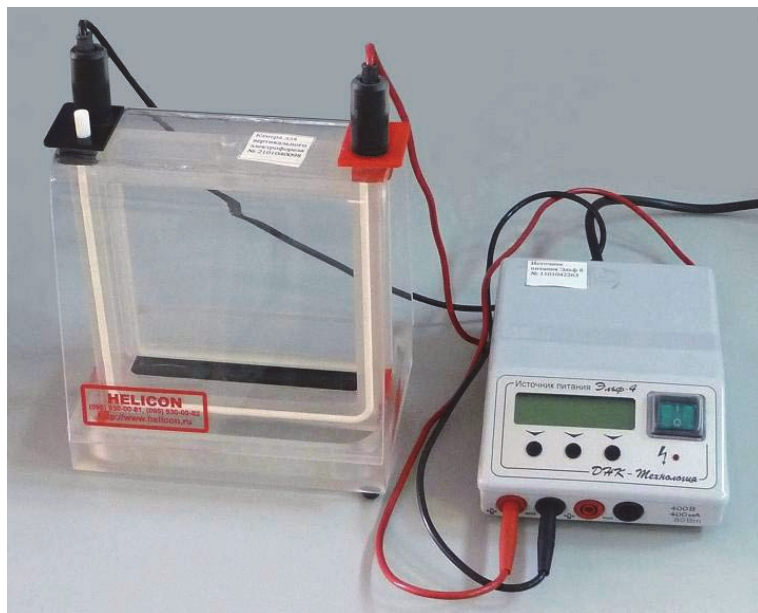
Рис. 5.7. Камера для проведения вертикального электрофореза ( Helicon ) в ПААГ и источник питания (ДНК-Технология).
