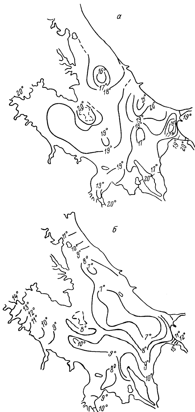
Рис. 12. Распределение температур в поверхностном (а) и придонном (б) слоях водохранилища 8 июня 1961 г.
