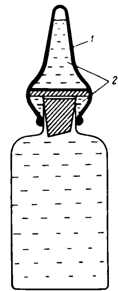
Рис. 38. Схема водного запора склянок при определении БПК.
