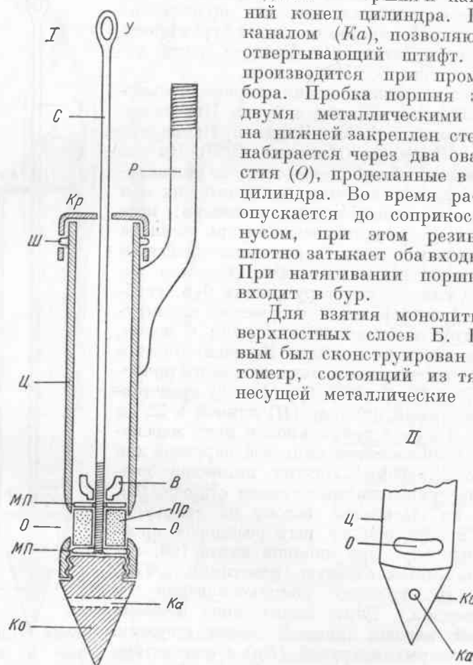
Фиг. 6. Поршневой бур, видоизмененный Н. В. Кордэ. (По Кордэ, 1953а).
